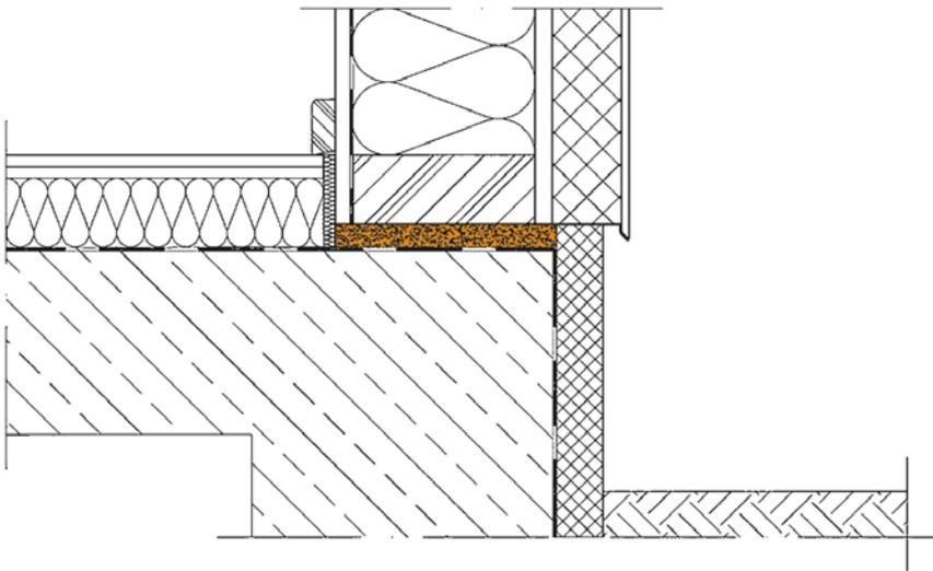
Die Wandelemente werden zunächst auf Holz- und Kunststoffklötzen ausgerichtet und die Zwischenräume anschließend mit fermacell™ Quellmörtel ausgefüllt.
